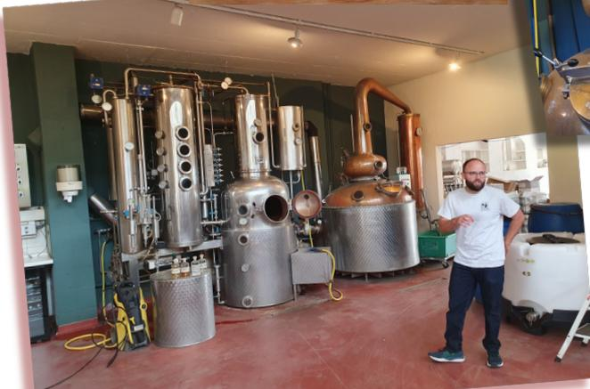
... Die Führung startete mit einem Überblick über ihre Destillationsapparaturen, links die älteste Anlage von 2002 (Kolonne), mit der sie auch heute noch viele Produkte destillieren, z.T. auch Whisky. Der Whisky, der einen ausgeprägten Körper und eine ölige Textur aufweisen soll, wird jedoch mit ihrer nach dem Vorbild der schottischen Macallan-Destillerie für sie extra konstruierten *Pot Still Anlage* (Foto oben) destilliert ...
